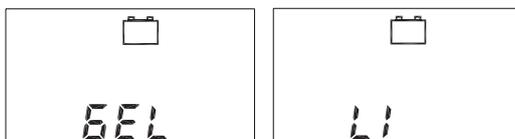
« LI » est le réglage par défaut. Le réglage du type de batterie a des conséquences sur la tension de fin de charge du régulateur. Si vous deviez utiliser une
