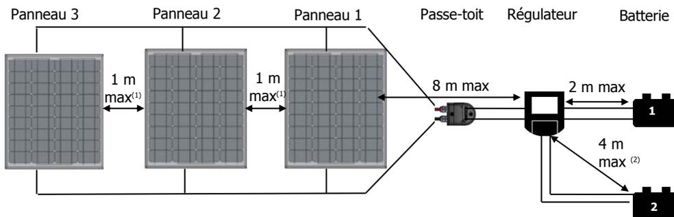
(1) Possibilité de rallonger la distance entre les panneaux d'un mètre supplémentaire, en rajoutant un Unicable 612B et 612 R (câbles non fournis avec les kits Uniconnect).
