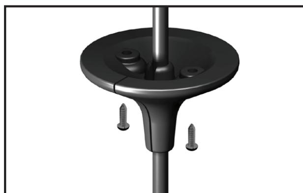
Maintenez l'Ulitium à la hauteur désirée. Ensuite, fixez le Couvercle du Plafond au plafond avec des vis, ainsi couvrant le trou au plafond.
